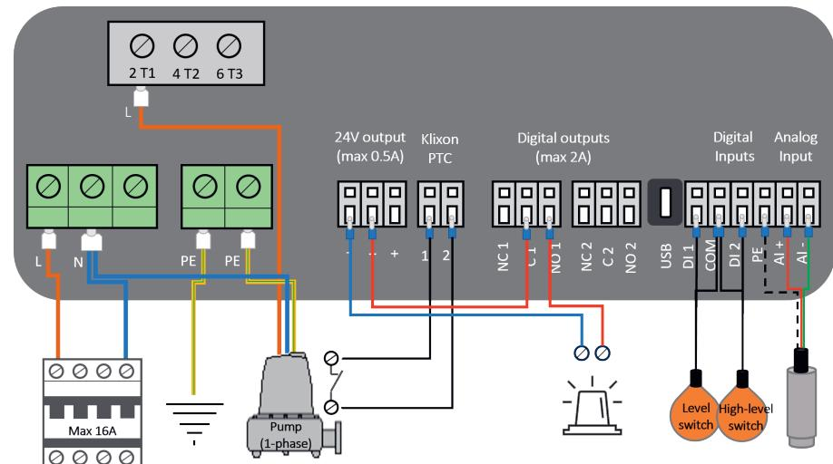
Montagevejledning ved brug af 3-faset pumpe. / Installation Guide for use with Three-Phase Pump.
